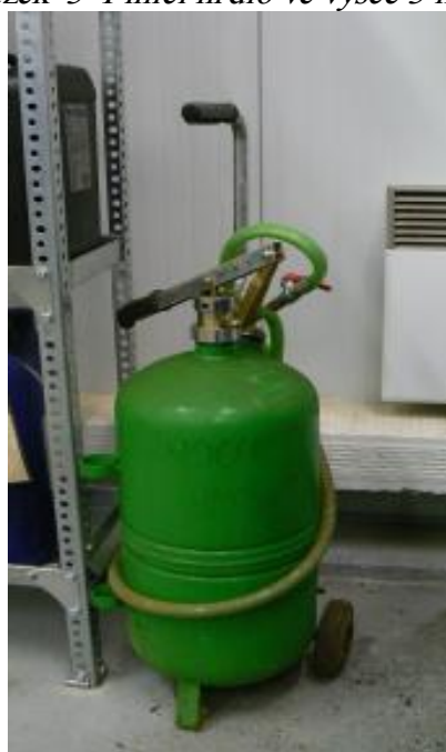
Obrázek 4 Vlevo pojízdná ruční přetlaková nádoba na doplňování – správná praxe, vpravo ukázka nesprávné praxe – chybějící víko a nesprávné uložení
